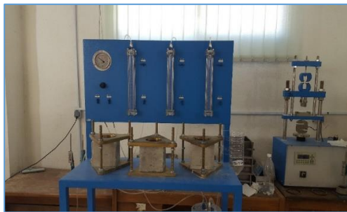
شکل ۶- دستگاه آزمون نفوذپذیری آب مطابق BS EN 12390-8 و نحوه قرارگیری نمونه‌ها تحت فشار ثابت 0.5 \text{ N/mm}^2 به مدت سه روز. پس از رهاسازی فشار و برش عمود بر سطح تماس، عمق نفوذ آب بر اساس بیشترین مقدار اندازه‌گیری‌شده در میان سه نمونه تعیین می‌شود.
