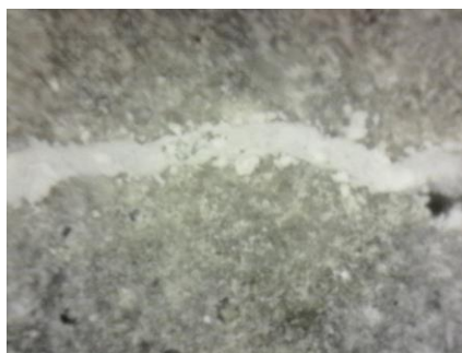
شکل ۴. پر شدن ترک توسط باکتری باسیلوس
