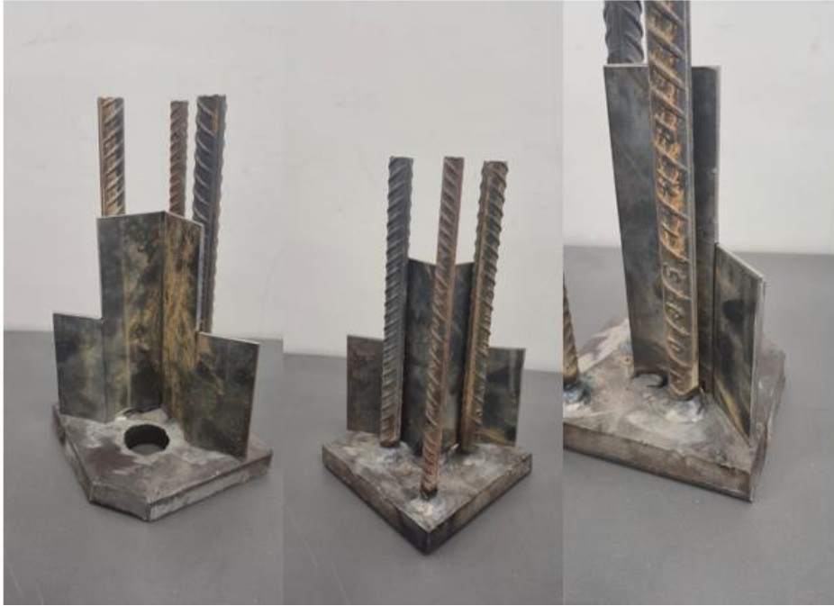
شکل ۲: کفشک فلزی مورد تحلیل در پژوهش حاضر [۴]
