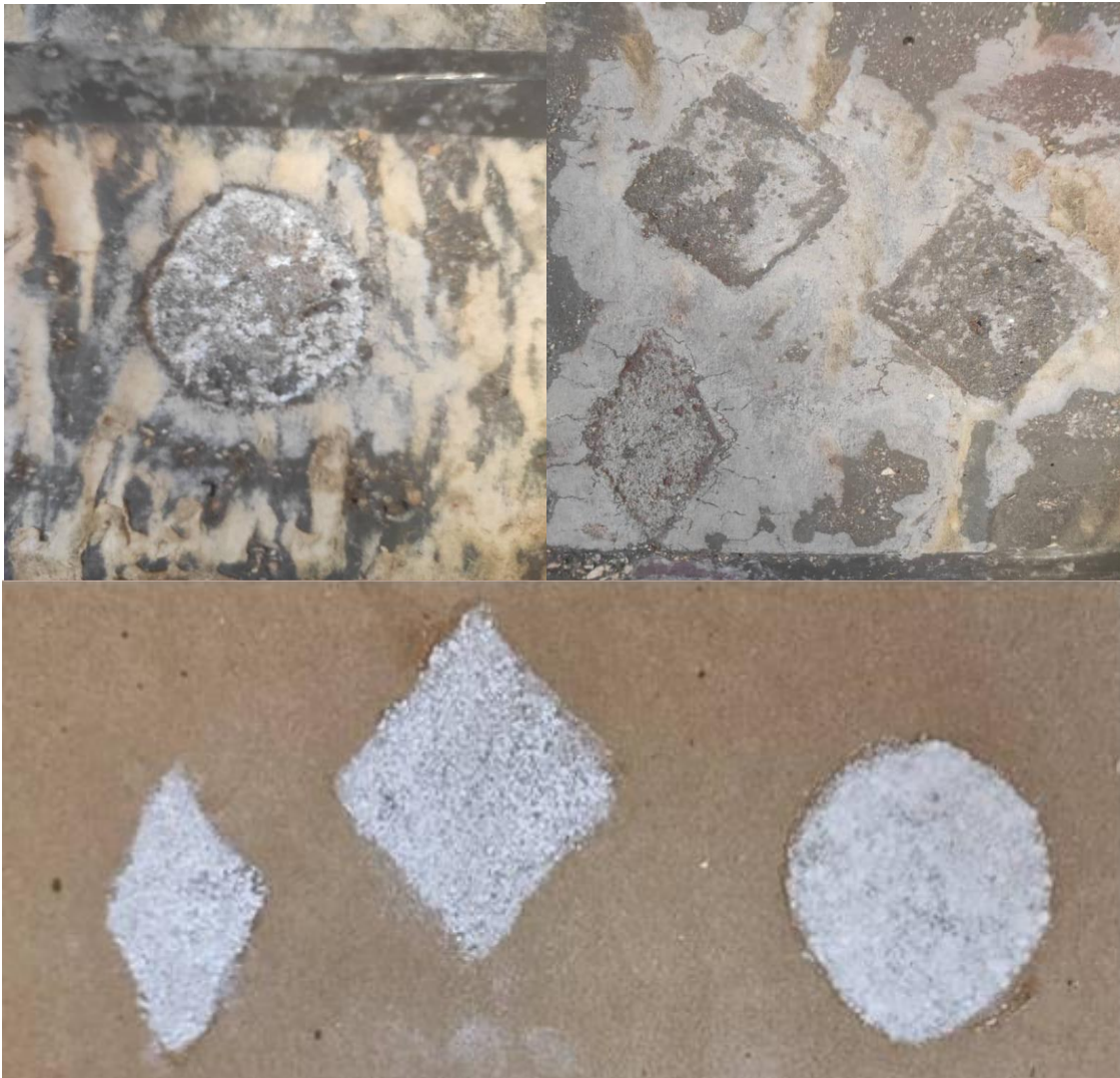
شکل ۳- نمونه طرحها و نتایج طرح بتنی با استفاده از ریتاردر گلوکونات که با پوشش لایه ای از پلی‌وینیل‌الکل و پلی‌اتیلن‌اکسید پوشانده شدند.
