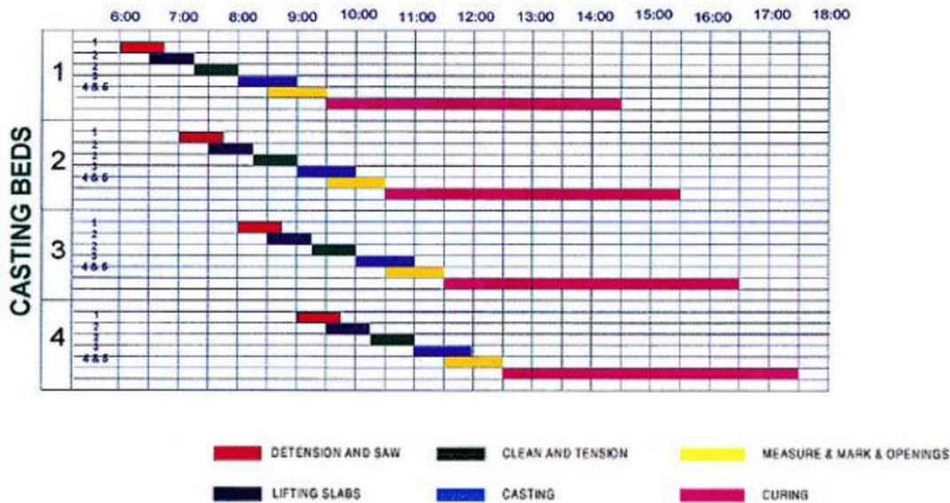
شکل ۳-۲۰ - رعایت پیوستگی زمانی در خصوص تولید قطعات هالوکور
