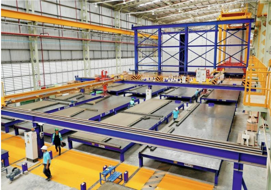
شکل ۳-۲۴ - تولید وال پنل به روش تولید ایستا در کارخانه BFT
