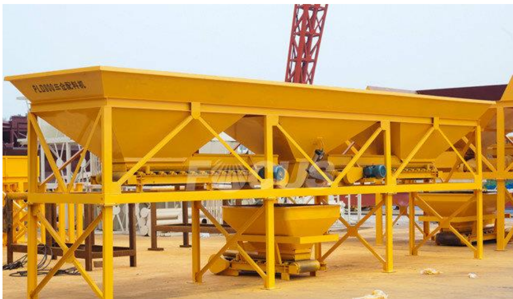
شکل ۳-۵- بچینگ فیدر (Aggregate Batching Machine) یا دستگاه توزین مصالح دانه‌ای که معمولاً در کارخانه‌های تولید قطعات پیش‌ساخته بتنی انتقال مواد خام به بچینگ را انجام میدهد.
